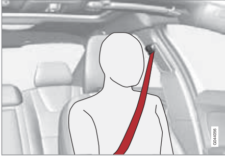
حزام الأمان مُركَّب بشكل صحيح.
