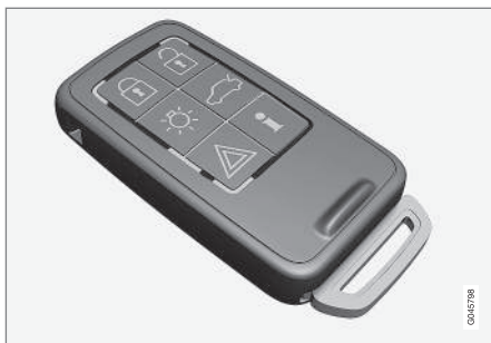
Télécommande avec VPC* - Personal Car Communicator.
