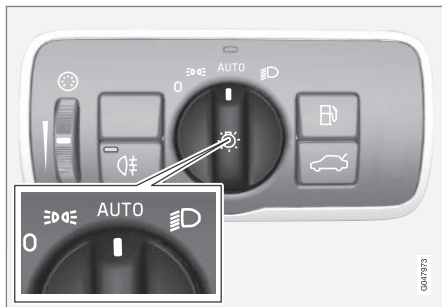
Bouton du commutateur d'éclairage en position AUTO .
