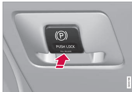
Commande de frein de stationnement - serrage.
