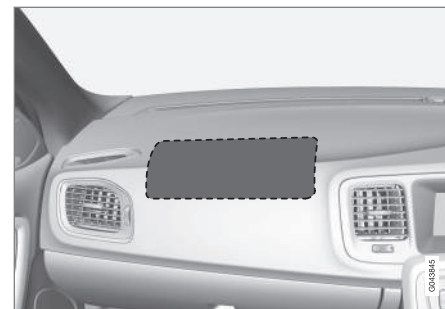
Emplacement du coussin gonflable (airbag) du côté passager dans les voitures à conduite à droite.
