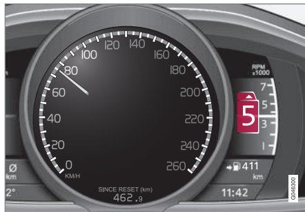
Combiné d'instruments numérique avec indicateur de rapport.
