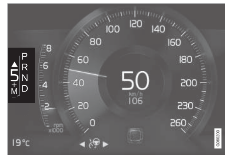
Wskaźnik zmiany biegu na 8-calowym wyświetlaczu kierowcy dla dużej dźwigni zmiany biegów.
