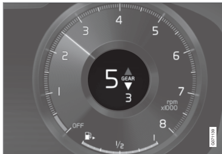
Wskaźnik zmiany biegu na 12-calowym wyświetlaczu kierowcy*.
