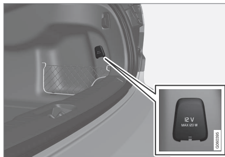
Gniazdo elektryczne 12 V w przestrzeni bagażowej*.
