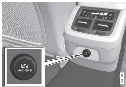
Gniazdo elektryczne 12 V w konsoli między fotelami, siedzenia tylne.
