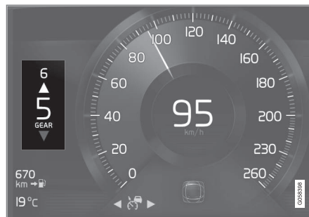
Wskaźnik zmiany biegu na 8-calowym wyświetlaczu kierowcy.
