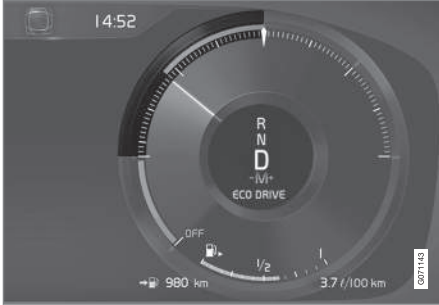
12 inç sürücü ekranındaki Eco göstergesi*.
