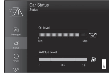
Orta gösterge ekranındaki yağ seviyesi grafikleri.
