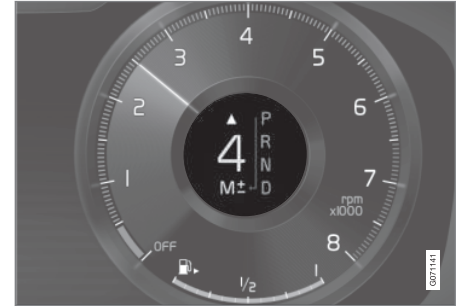
Büyük vites kolu* için 12 inç sürücü gösterge ekranındaki vites değiştirme göstergesi.
