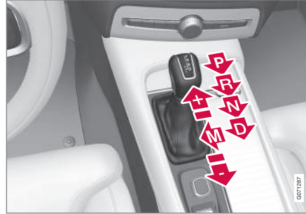
Büyük vites kolu ve vites konumlarına genel bakış.
