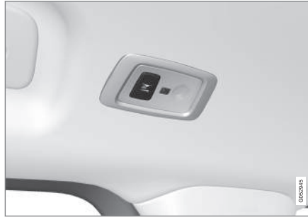
Panorama tavanı* olan araçlarda tavanın her iki tarafında birer tane olmak üzere iki lamba ünitesi vardır. 10
