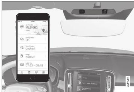
Es posible, por ejemplo, bloquear o desbloquear el automóvil o comprobar el nivel de combustible directamente en el teléfono mediante la aplicación Volvo On Call. Si se ha producido un accidente, se puede enviar ayuda de emergencia al vehículo en forma, por ejemplo, de ambulancia o policía. Si se trata de un problema de menor importancia, como un pinchazo, se puede solicitar asistencia en carretera.
