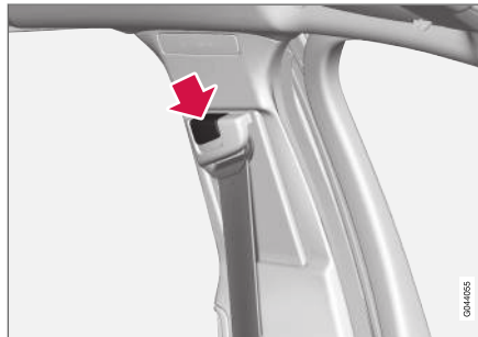
Regulacja wysokości pasa bezpieczeństwa. Nacisnąć przycisk i przesunąć pas w kierunku pionowym. Ustawić pas możliwie jak najwyżej, ale w taki sposób, by nie ocierał się o szyję.
