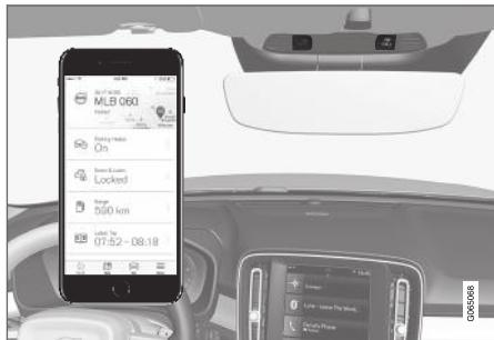
So haben Sie in der App Volvo On Call auf Ihrem Smartphone z. B. die Möglichkeit, das Fahrzeug zu ver- und zu entriegeln oder den Kraftstoffstand zu prüfen. Bei einem Unfall lassen sich die benötigten Einsatzkräfte wie Polizei oder Krankenwagen direkt an den Unfallort entsenden. Bei einer Reifenpanne oder anderen weniger akuten Problemen können Sie über die App Pannenhilfe anfordern.
