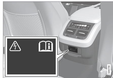
Электрическое гнездо в тоннельной консоли, заднее сиденье.
