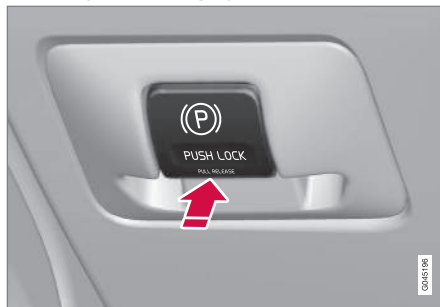
Елемент керування паркувальним гальмом - увімкнення.
