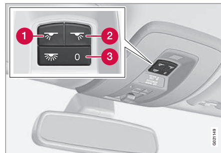
Елементи керування в даховій консолі для передніх ламп та загальних ламп освітлення салону.
