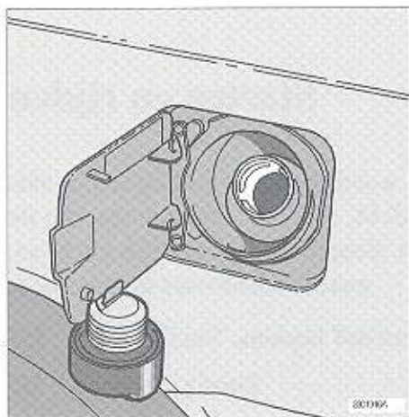
Vulpijp met vernauwing voor auto's met katalysator
