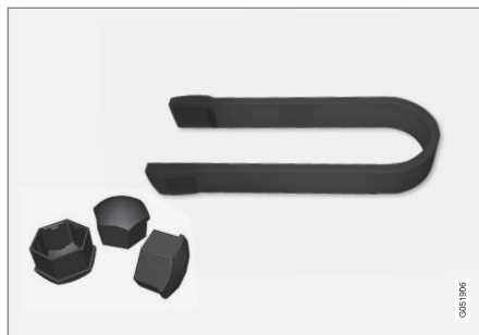
Nástroj pro sejmutí plastových krytek šroubů kol.
