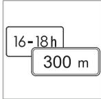
Algumas velocidades são válidas após, por exemplo, um determinado trajecto ou durante determinadas horas do dia. O condutor é alertado para estas condições com um símbolo de sinal adicional sob o
