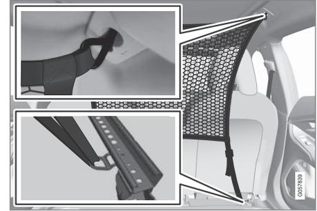
1. Engate os ganchos na fixação do teto com o trinco da correia de aperto virado para si.
