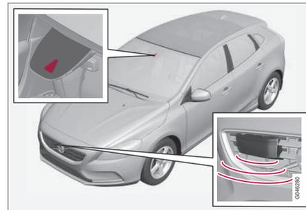
Sensor de radar e de câmara<sup>23</sup>.
