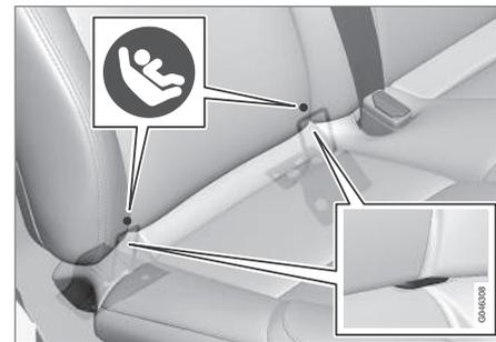
Os pontos de fixação para o sistema de fixação ISOFIX encontram-se junto à parte inferior das costas do banco traseiro, nos lugares exteriores.
