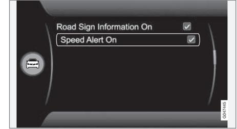
O condutor pode seleccionar se pretende obter um aviso quando o limite de velocidade é ultrapassado em 5 km/h (3 mph) ou mais. O aviso é efectuado através de um símbolo a piscar com a velocidade máxima aplicável enquanto a mesma é ultrapassada.
