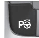
1. Ative o PAP pressionando este botão e conduza a uma velocidade inferior a 30 km/h (20 mph).
