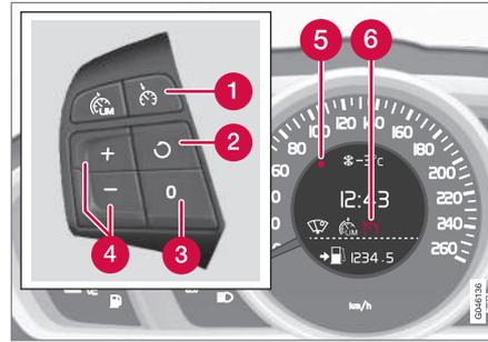
Teclado do volante e mostrador no automóvel **com** Limi-tador de velocidade<sup>4</sup>.
