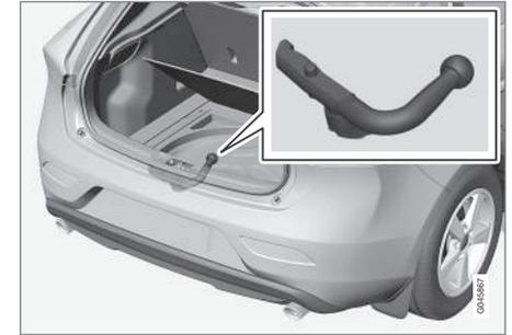
Quando não utilizado, o engate de reboque amovível deve ser guardado no bloco de espuma<sup>10</sup> sob o chão da carga.
