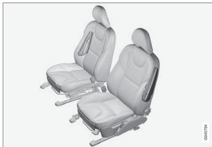
O sistema de airbags SIPS é composto por duas partes principais: o airbag lateral e os sensores. Os airbags laterais encontram-se montados na estrutura das costas dos assentos da frente.
