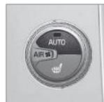
Rode o botão para aumentar ou diminuir a velocidade do ventilador, **AUTO** é desligado. Se for seleccionado **AUTO**, a velocidade do ventilador é regulada automaticamente (pág. 139) - a velocidade anteriormente ajustada é desactivada.
