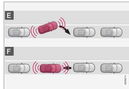
Após o automóvel ter efectuado a marcha-atrás no espaço de estacionamento é necessário ajustá-lo.
