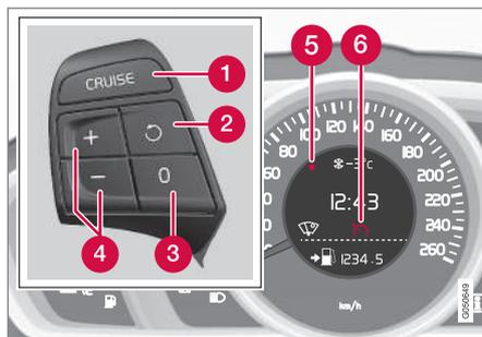
Teclado do volante e mostrador no automóvel **sem** Limiteador de velocidade<sup>6</sup>.
