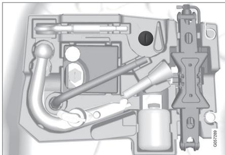
5. Agarre a estrutura da roda sobresselente e levante. Desloque a roda sobresselente ligeiramente para a frente e levante-a do espaço de arrumação.
