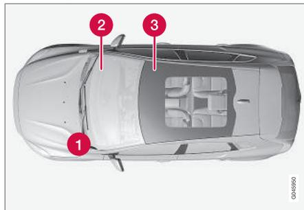
Localização das centrais eléctricas em modelos com volante à esquerda, no caso do automóvel ter volante à direita, a central muda sob o lado do porta-luvas.
