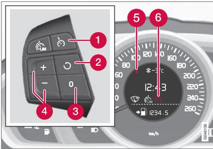
Teclado do volante e instrumento combinado no automóvel **com** Limitador de velocidade<sup>2</sup>.
