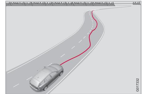
Uma câmara faz a leitura das marcações laterais pintadas na estrada e compara o desenvolvimento das marcações com os movimentos do volante executados pelo condutor. O condutor é alertado quando o veículo não acompanha a estrada de forma regular.
