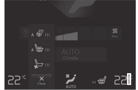
Ohjauspyörän ja istuimen painikkeet ilmastointirivissä.
