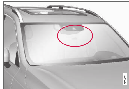
Posizione del gruppo radar.
