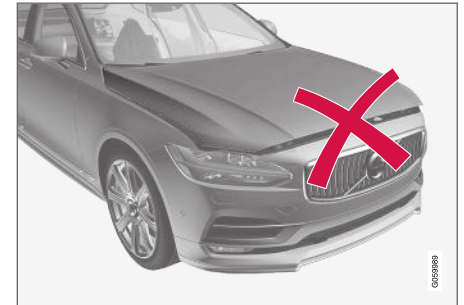
Cofano non completamente chiuso.
