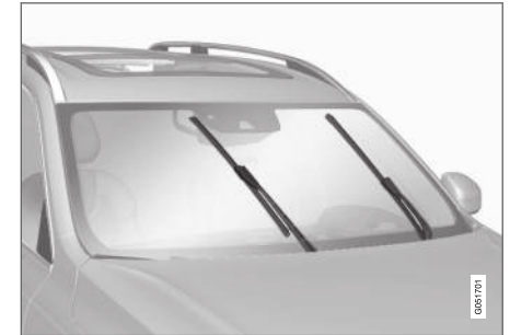
Spazzole tergicristallo in posizione di assistenza.
