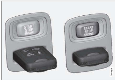
Zündschloss mit herausgezogenem/ingedrücktem Transponderschlüssel.
