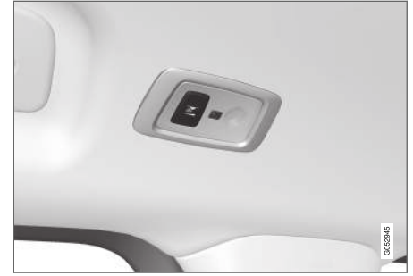
Panorama tavanı* olan araçlarda tavanın her iki tarafında birer tane olmak üzere iki lamba ünitesi vardır. 7
