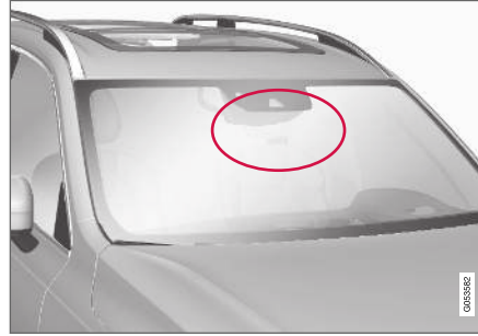
Radar ünitesi konumu
