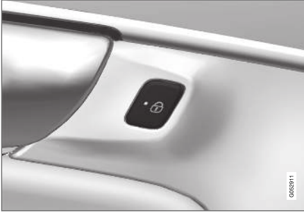
Arka kapıda gösterge lambalı kilit düğmesi.
