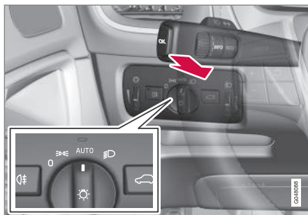
Stuurhendel en verlichtingsdraaiknop in stand AUTO .
