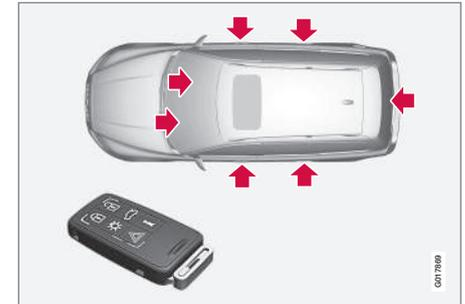
Points de verrouillage de la télécommande **avec** lame de clé.
