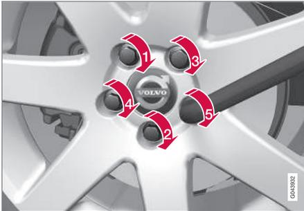
4. Serrez fermement les boulons de roue en croix et de manière alternée. Il est important que les boulons de roue soient correctement serrés. Couples de serrage : 140 Nm. Vérifiez le serrage des écrous à l'aide d'une clé dynamométrique.
