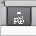
1. Activez la fonction PAP par une pression sur ce bouton et ne dépassez pas 30 km/h (20 mph).
