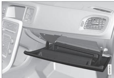
Le manuel de l'utilisateur et les cartes routières par exemple peuvent être rangés à cet endroit. Il y a un porte-stylo sur la face intérieure de la porte de la boîte à gants. La boîte à gants peut être verrouillée \* (p. 189) avec la lame de clé (p. 178).
