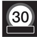
Un panneau complémentaire symbolisé par un cadre vide sous le panneau de limitation de vitesse<sup>26</sup> sur le combiné d'instruments signifie que le RSI a détecté un panneau comportant des informations
