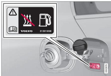
Le bouchon du réservoir peut être accroché à la trappe.
