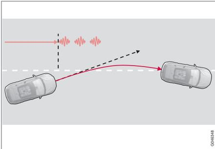
LKA intervient et avertis le conducteur par des vibrations au volant<sup>32</sup>.
