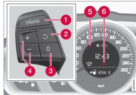
Clavier au volant et combiné d'instruments dans une voiture **sans** limiteur de vitesse<sup>2</sup>.
