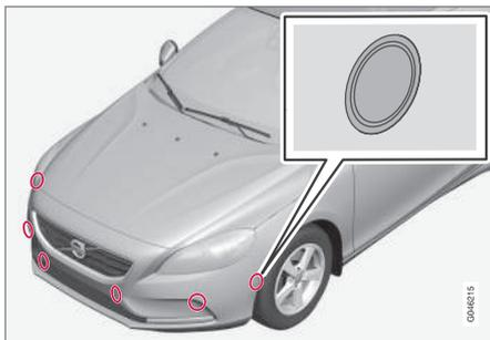
Les capteurs PAP se trouvent dans les pare-chocs<sup>40</sup> : 6 à l'avant et 4 à l'arrière.
