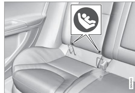
Les points de fixations du système ISOFIX sont dissimulés dans la partie inférieure du dossier de la banquette arrière, aux places extérieures.
