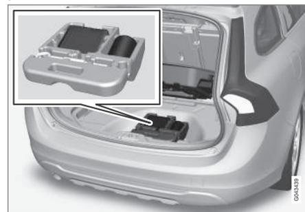
Le kit de réparation de crevaison se trouve sous le plancher du compartiment à bagages.
