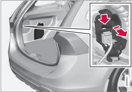
Les ampoules es clignotants, de feux antibrouillard et de recul dans le combiné arrière doivent être remplacées à partir du compartiment à bagages.
