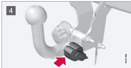
4 Insérez et faites coulisser le crochet jusqu'à ce qu'un déclic se fasse entendre.
