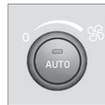
Tournez la molette pour augmenter ou réduire la vitesse du ventilateur. Si **AUTO** est sélectionné, la vitesse du ventilateur est régulée automatiquement (p. 143) - le réglage de la vitesse du ventilateur est
