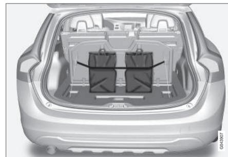
Dispositif de retenue pour sacs à provisions sous la trappe rabattable du plancher.
