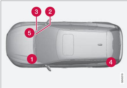
Emplacement des centrales sur une voiture avec conduite à gauche. Pour les voitures avec conduite à droite, les centrales se trouvent du côté de la boîte à gants.
