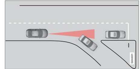
Si le véhicule cible qui précède change brusquement de direction, la circulation peut être arrêtée un peu plus loin.
