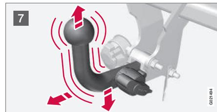
7 Contrôlez que le crochet est bien fixé en la frappant vers le haut, le bas et l'arrière.
