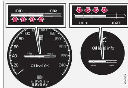
Les chiffres 1 à 4 représentent le niveau de remplissage. Ne rajoutez pas plus d'huile si le niveau de rem-
