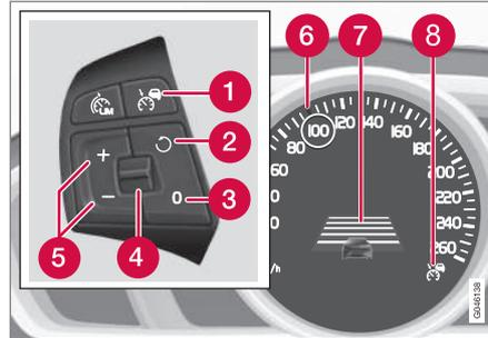
Régulateur adaptatif de vitesse **avec** Limiteur de vitesse<sup>9</sup>.
