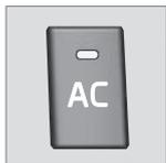
Lorsque le témoin du bouton **AC** est allumé, la climatisation est commandée automatiquement par le système.
