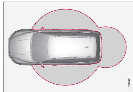
Les anneaux rouges de l'illustration ci-dessus indiquent les zones couvertes par les antennes du système.
