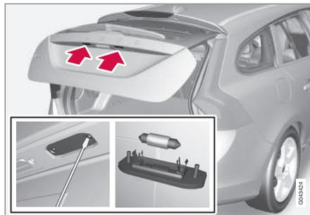
1. Desserrez les vis avec un tournevis.
