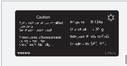
L'autocollant est placé sur la face intérieure du capot moteur.
