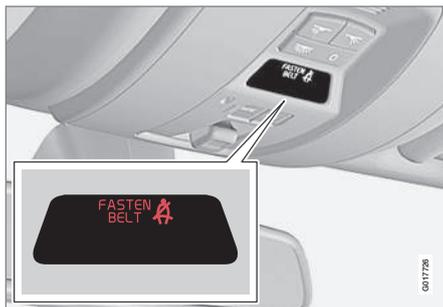
Le rappel sonore dépend de la vitesse et parfois du temps. Le rappel lumineux est situé dans la console du plafond et dans le combiné d'instruments (p. 68).
