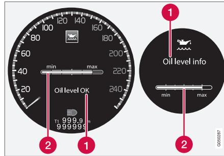
Un message et une représentation graphique apparaissent à l'écran. L'écran gauche affiche le combiné d'instruments numérique et le droit, le combiné d'instruments analogique.
