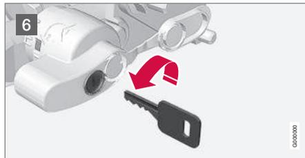
6 Tournez la clé dans le sens inverse des aiguilles d'une montre jusqu'en position de verrouillage. Retirez la clé de la serrure.
