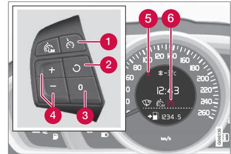
Clavier au volant et combiné d'instruments dans une voiture **avec** limiteur de vitesse<sup>2</sup>.
