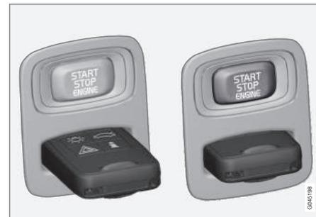
Contacteur d'allumage avec télécommande retirée/insérée.
