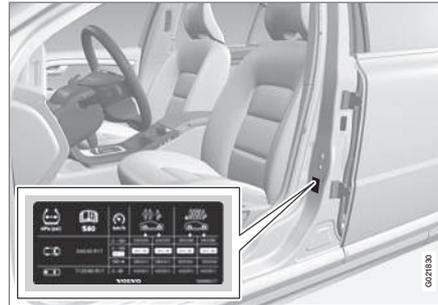
L'autocollant de pressions de pneu sur l'intérieur du montant de porte du côté conducteur (entre les portes avant et arrière) quelle pression les pneus doivent avoir à différentes conditions de charge et de vitesse. La pression correcte est aussi indiquée dans le tableau de pressions de pneu, référez-vous à Pneus - Pressions de pneus admises (p. 452).
