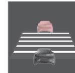
Ce n'est que lorsqu'un autre véhicule apparaît à l'écran que la **distance** avec le véhicule qui précède est gérée par l'ACC.
