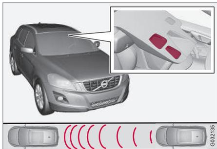
Fenêtre d'émission et de réception du capteur laser<sup>13</sup>.
