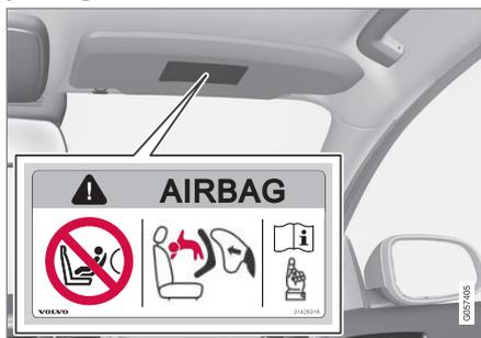
Autocollant sur le pare-soleil du côté passager.
