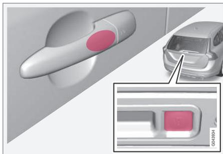
La zone tactile sur la poignée extérieure des portes et le bouton caoutchouté près du bouton gainé de caoutchouc du hayon.
