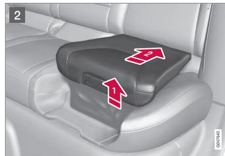
**2** Levez le bord avant du coussin d'assise et poussez-le vers l'arrière contre le dossier pour le verrouiller.
