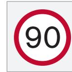
L'avertissement de vitesse est émis sous la forme d'un symbole<sup>26</sup> sur le combiné d'instruments indiquant la vitesse maximale autorisée qui clignote lorsque la vitesse est dépassée d'au moins 5 km/h (5 mph).
