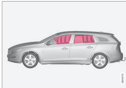
Le rideau gonflable IC (Inflatable Curtain) est un composant du système SIPS (p. 38) et du système de coussins gonflables (p. 33). Il est monté le long des deux côtés du plafond et aide à protéger le conducteur et les passagers assis sur les sièges extérieurs de la voiture. Lors d'une forte collision, les capteurs réagissent et le rideau gonflable se gonfle.
