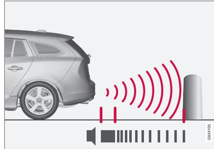
La zone de détection derrière la voiture est d'environ 1,5 m. Le signal sonore indiquant un obstacle à l'arrière provient de l'un des haut-parleurs arrière.
