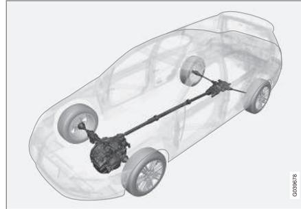
La transmission intégrale (All Wheel Drive) signifie que la voiture est entraînée simultanément par les quatre roues.
