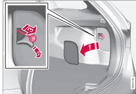
1. Ouvrez et écartez la trappe latérale dans le compartiment à bagages (du même côté que la trappe du réservoir).
