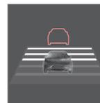
Il est possible de choisir parmi différentes distances temporelles au véhicule qui précède. Elles sont représentées sur le combiné d'instruments par des traits horizontaux (entre 1 et 5) - plus ils sont nombreux, plus la distance temporelle est longue. Un trait correspond à environ 1 seconde jusqu'au véhicule qui précède et 5 traits à environ 3 secondes.
