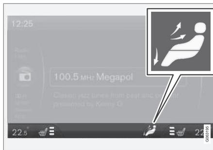
La répartition de l'air sélectionnée apparaît sur l'écran de la console centrale.
