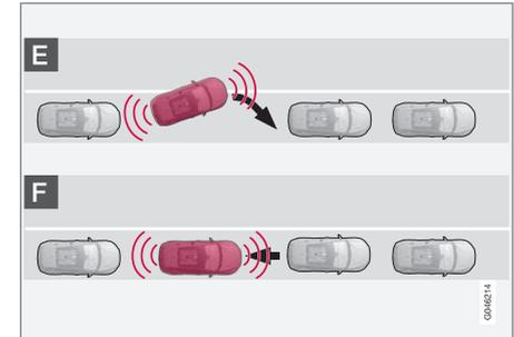
Après avoir reculé dans l'espace de stationnement, la voiture doit être correctement placée.
