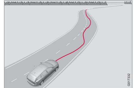
Une caméra détecte le marquage au sol et compare son tracé aux mouvements du volant. Le conducteur est averti lorsque le véhicule ne suit pas la chaussée de façon régulière.
