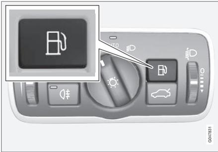
La trappe de réservoir de carburant est déverrouillée et ouverte grâce au bouton du panneau d'éclairage. La trappe s'ouvre lorsque vous relâchez le bouton.
