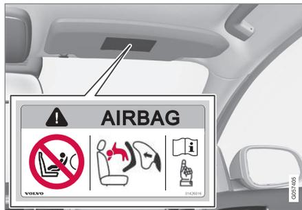
Autocollant sur le pare-soleil du côté passager.
