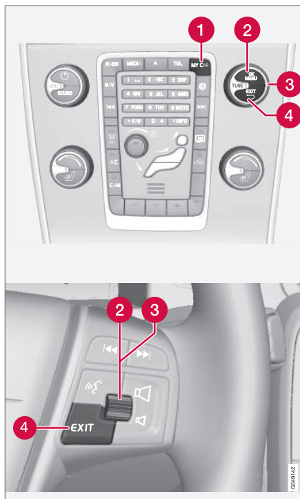
Keskkonsooli juhtpaneel ja rooli klahvistik. Kujutus on näitlik - funktsioonide arv ja nuppude paigutus
