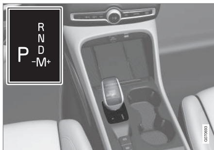
Panorâmica geral de alavanca das mudanças pequena e padrões de mudanças no mostrador do condutor.
