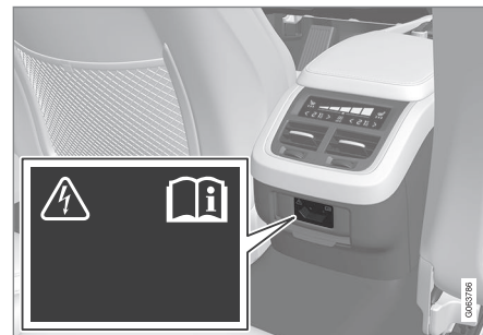
Tomada eléctrica na consola de túnel, banco traseiro.
