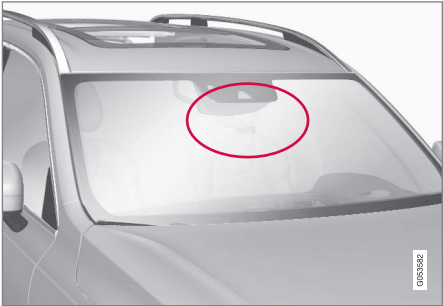
La zone indiquée ne doit pas être couverte (ni autocollant, ni filtre solaire, ni aucun autre objet, etc.) 12 .
