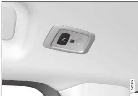
У автомобілях з панорамним дахом* є два блоки ламп, по одному з кожного боку даху.
