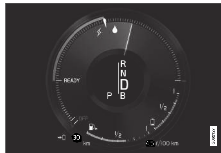
Дисплей водія відображує інформацію як про електротягу, так і про привід від ДВЗ.
