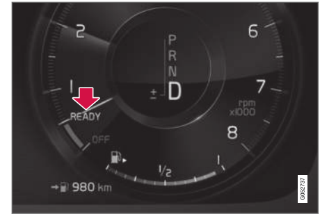
La fonction est active et le moteur du véhicule a été arrêté automatiquement.
