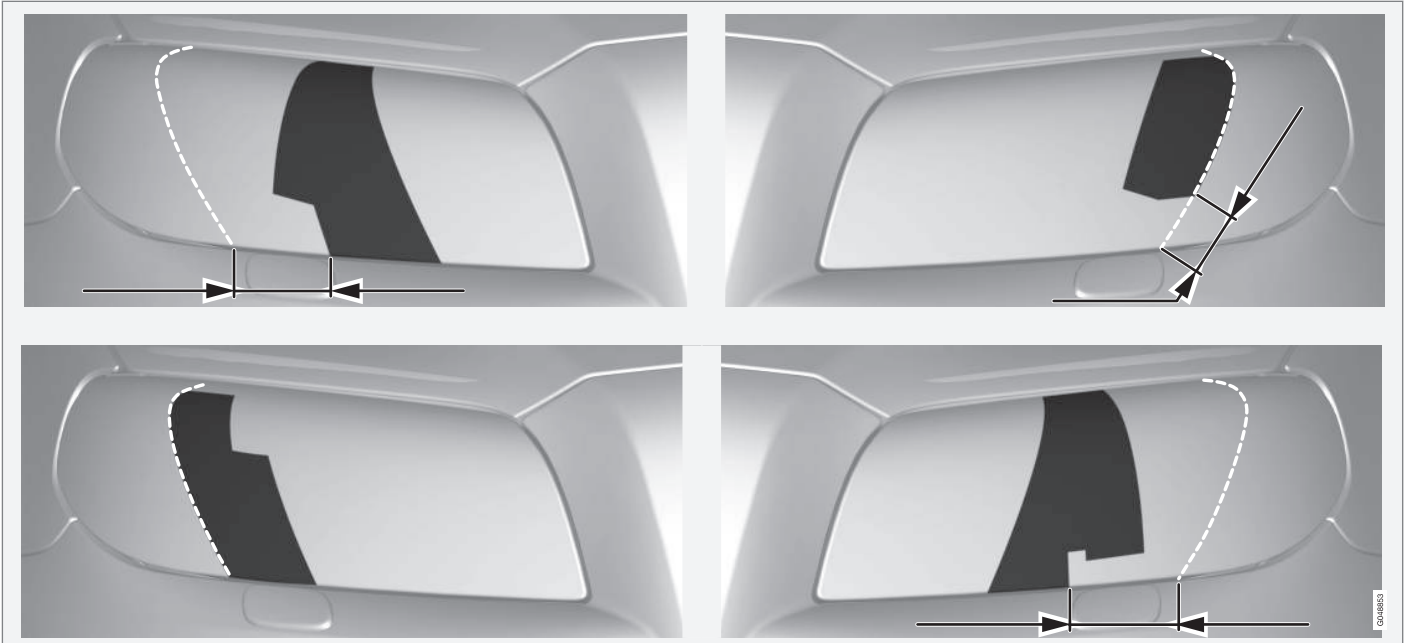
Üst sıra: soldan direksiyonlu araçlar, A ve B şablonları. Alt sıra: sağdan direksiyonlu araçlar, C ve D şablonları.
