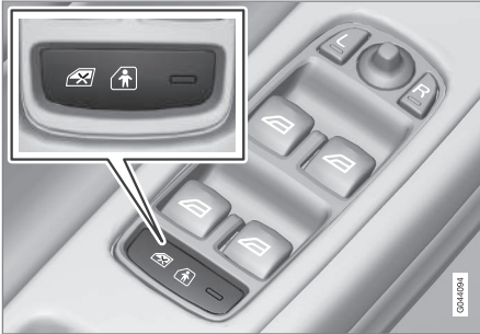
Kumanda paneli sürücü kapısı.
