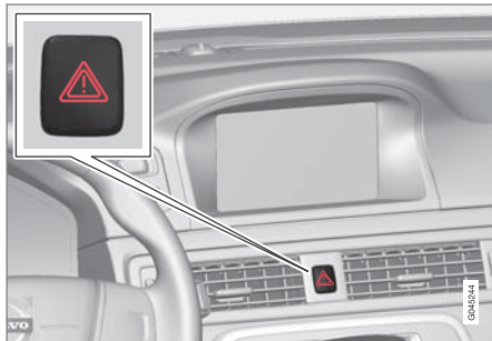
非常点滅灯ボタン
