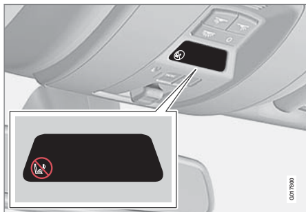
助手席側エアバッグが作動状態であることを表示するインジケーター
