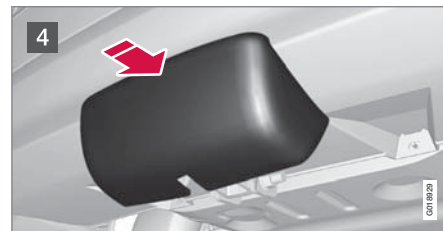
4 プロテクティブカバーをカチッと音がするまで押し込みます。
