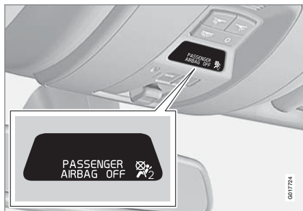
助手席側エアバッグが非作動状態であることを表示するインジケーター
