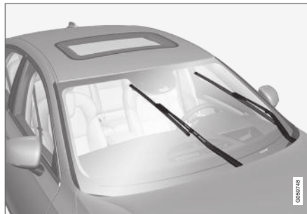
Balais d'essuie-glaces en position d'entretien.
