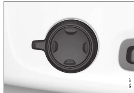
Commande multifonction du côté de l'assise de siège.
