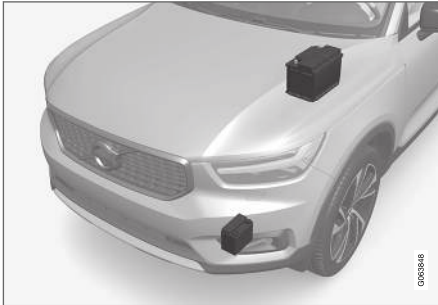
A segédakkumulátor lent a motortérben található. Az indítóakkumulátor is itt látható (fent).
