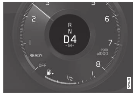
A járművezetői kijelző, amikor a kormánykerék füleivel vált sebességfokozatot.
