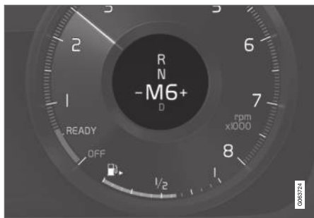
manuális fokozatváltási mód a járművezetői kijelzőn.
