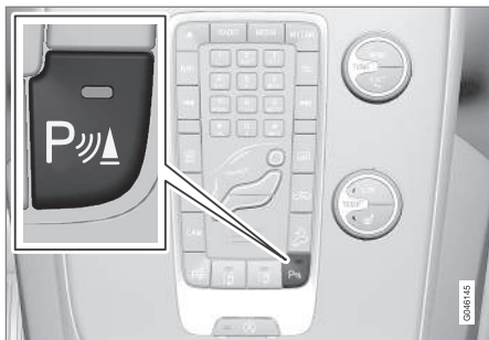
Til-/fra for sensorerne til Parkeringshjælp og CTA.
