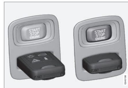
Tændingslås med fjernbetjening skubbet ud/trykket ind.
