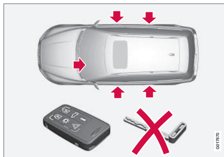
Låsepunkter for fjernbetjening uden nøgleblad og aktiveret privatlåsning.
