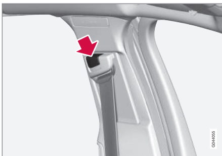
Højdejustering af sikkerhedsselen. Tryk på knappen og bevæg selen i højden. Anbring selen så højt som muligt, uden at den gnider mod halsen.
