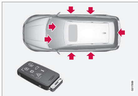
Låsepunkter for fjernbetjening med nøgleblad.
