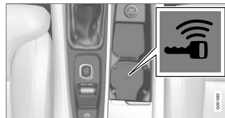
Расположение резервного считывающего устройства в тоннельной консоли.
