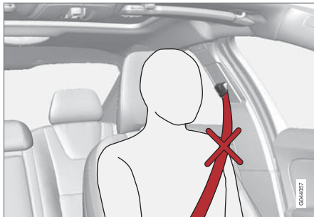
حزام الأمان مُركب بشكل غير صحيح. يجب أن يستند الحزام على الكتف.
