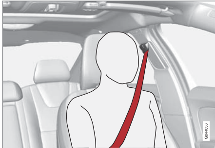
حزام الأمان مُركب بشكل صحيح.
