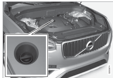
フィラーパイプ 1314
