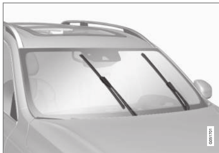
Torkarblad i serviceläge.
