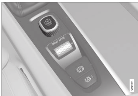
Startvredet i tunnelkonsolen.
