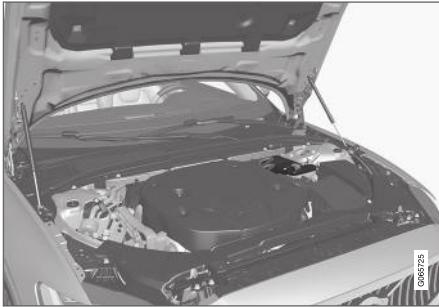
Stödbatteriet är placerat i motorrummet.
