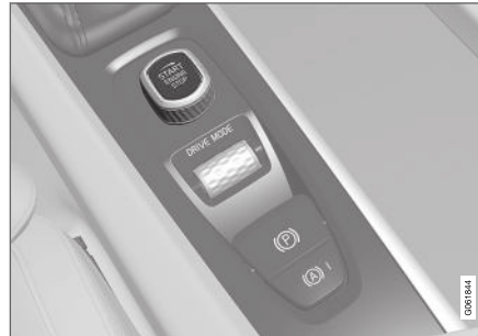
Startvredet i tunnelkonsolen.
