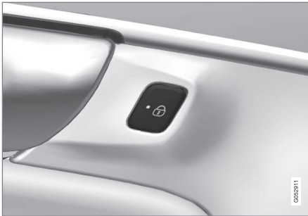
Låseknop med indikeringslampe i bagdør.
