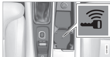
Backup-læserens placering i tunnelkonsollen.
