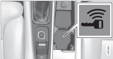
Backup-læserens placering i tunnelkonsollen.
