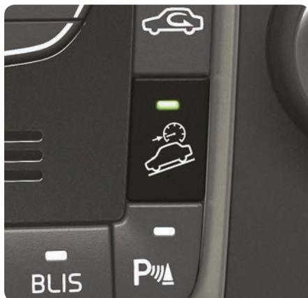
O Hill Descent Control (HDC) permite aumentar/diminuir a velocidade em descidas acentuadas utilizando apenas o pedal do acelerador, para que a atenção possa ser colocada na direção.
