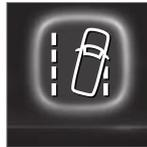
Dieses Symbol auf dem Fahrerdisplay zeigt an, dass LKA aktiviert ist und laufend kontrolliert, dass der Fahrer beide Hände noch am Lenkrad hat.
