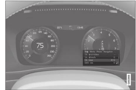
Bestimmte Apps können Sie nicht nur über das Center Display, sondern auch über das App-Menü auf dem Fahrerdisplay bedienen. Die Abbildung ist schematisch - die Anordnung kann abweichen.
