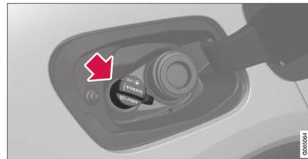
Öffnen Sie den blauen Verschluss zum kleineren Einfüllstutzen, der für AdBlue vorgesehen ist.
