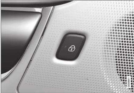
Verriegelungstaste mit Anzeigeleuchte an der Fondtür.
