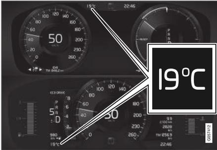
Lage des Außentemperaturmessers auf dem 12- bzw. 8-Zoll-Fahrerdisplay.
