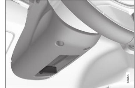
Hebel für die Lenkradverstellung.
