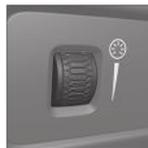
Mit dem links neben dem Lenkrad befindlichen Rändelrad am Armaturenbrett stellen Sie die Helligkeit von Display-, Schalter-, Dekor- und Ambientebeleuchtung\* einstellen.
