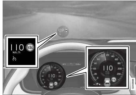
In der obigen Abbildung<sup>66</sup> ist die adaptive Geschwindigkeitsregelung auf 110 km/h (68 mph) eingestellt, und das Fahrzeug kann keinem vorausfahrenden Fahrzeug folgen.
