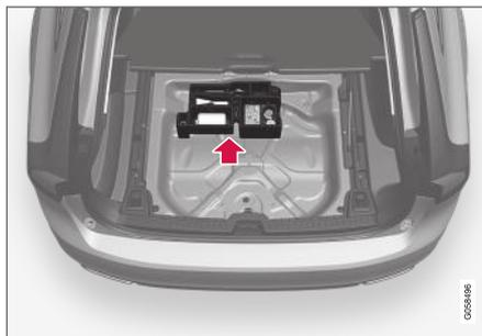
Im Schaumblock unter dem Kofferraumboden befinden sich die Abschleppöse, das Reifenpannen-Set, das Werkzeug zum Entfernen der Plastikaufsätze an den Radmuttern und der Steckaufsatz für die abschließbaren Radmuttern.
