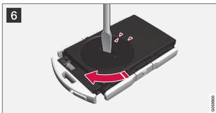
**6** Setzen Sie den Batteriedeckel wieder ein und drehen Sie die Markierung auf den Text **CLOSE**.
