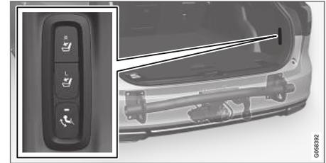
Öffnen Sie die Heckklappe. An der rechten Kofferraumwand befindet sich ein Schalter zum Ein- und Ausklappen der Anhängerkupplung. Damit die Anhängerkupplung ausgeklappt werden kann, muss die Anzeigelampe des Schalters orange leuchten.
