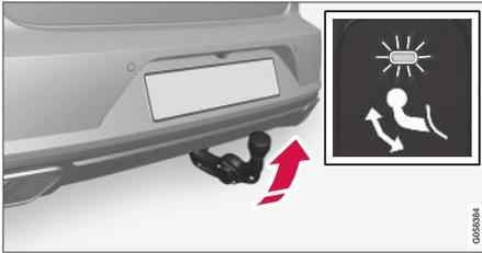
Drücken Sie den Schalter und lassen Sie ihn wieder los. Ein zu langes Drücken des Schalters kann dazu führen, dass der Ausklappvorgang nicht gestartet wird.
