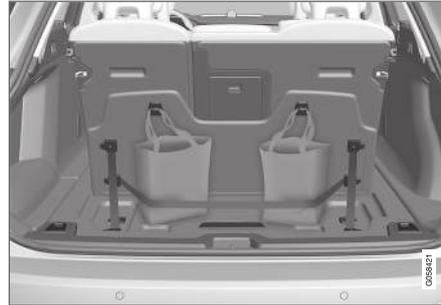
Im Deckel der Bodenklappe befinden sich zwei Taschenhaken und ein elastisches Spannband<sup>3</sup>. Das Band lässt sich in vier Lagen befestigen.
