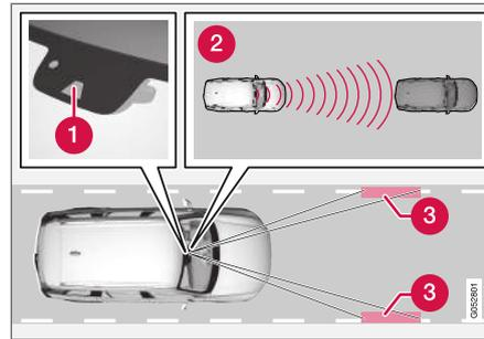
Die Kamera- und Radarsensoren messen den Abstand zum vorausfahrenden Fahrzeug und erkennen seitliche Fahrbahnmarkierungen<sup>67</sup>.
