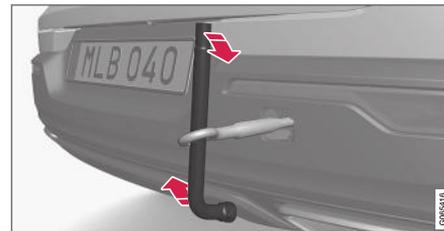
Öse ordentlich festziehen, dafür als Hebel zum Beispiel den Radmutter Schlüssel\* verwenden.
