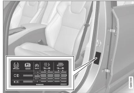
Auf dem Aufkleber finden Sie die Bezeichnung der ab Werk montierten Reifen sowie die geltenden Tragfähigkeitsgrenzen und Fülldrücke.
