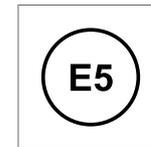
Bei E5 handelt es sich um Benzin, das bis zu 2,7 % Sauerstoff und bis zu 5 Vol.-% Ethanol enthält.
