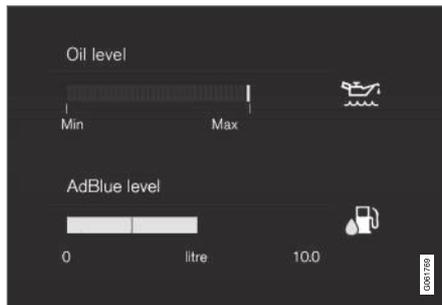
Darstellung für den AdBlue-Füllstand im Center Display.
