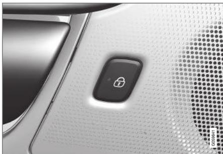
Verriegelungstaste mit Anzeigeleuchte an der Hintertür.
