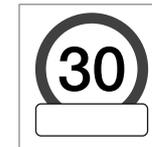
Ein Symbol für ein Zusatzschild in Form eines leeren Rahmens unter dem Geschwindigkeitssymbol<sup>105</sup> im Fahrerdisplay bedeutet, dass das RSI ein Zusatzschild mit zusätzlichen Informationen zur aktuellen
