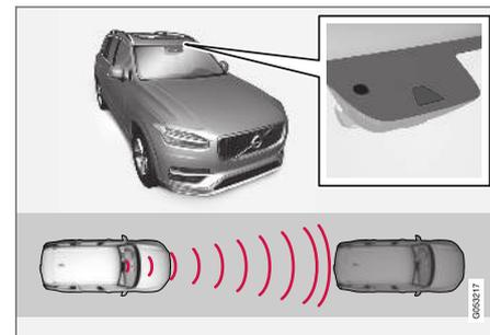
Die Kamera- und Radarsensoren messen den Abstand zum vorausfahrenden Fahrzeug<sup>47</sup>.
