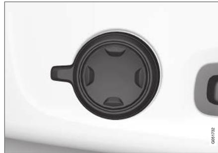
Multifunktionsschalter, in Fahrzeugen mit Vier-Wege-Lendenwirbelstütze\*.
