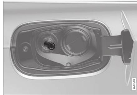
Das Autogas am Gasnippel einfüllen, der sich bei der Tankklappe befindet.
