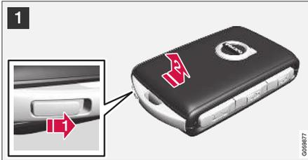
**1** Halten Sie den Transponderschlüssel so, dass die Vorderseite nach oben weist und das Volvo-Logo richtig ausgerichtet liegt. Schieben Sie den Schalter beim Schlüsselring am unteren Rand nach rechts. Drücken Sie die vordere Abdeckung einige Millimeter nach oben.
