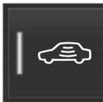
Um die Sicherheitsverriegelung vorübergehend zu deaktivieren, in der Ansicht Funktionen des Center Displays auf **Verminderter Schutz** tippen.
