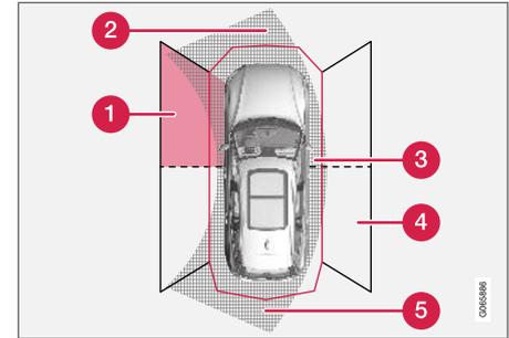
Sektoren, in denen die Sensoren der Einparkhilfe Hindernisse erfassen können<sup>130</sup>.
