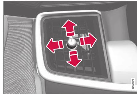
Hebel an der Belüftungsdüse<sup>2</sup>.
