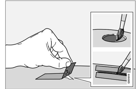
1. Auf die beschädigte Oberfläche ein Stück Abdeckband kleben. Anschließend das Band abziehen, so dass sich mit ihm eventuelle Lackreste lösen.
