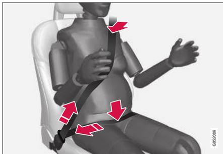
Der Sicherheitsgurt muss dicht an der Schulter anliegen, der Diagonalteil des Sicherheitsgurtes muss zwischen den Brüsten zur Seite des Bauches geführt werden.
