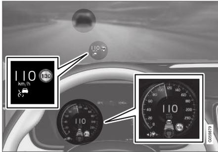
In der obigen Abbildung<sup>74</sup> ist die Funktion Pilot Assist auf 110 km/h (68 mph) eingestellt, und das Fahrzeug folgt einem vorausfahrenden Fahrzeug mit der gleichen Geschwindigkeit.
