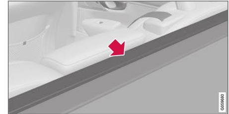
Klappen Sie die vordere Abdeckplatte der Gepäckraumabdeckung nach vorne, um den Zwischenraum zwischen der Gepäckraumabdeckung und der Rückenlehne des Rücksitzes zu überbrücken.
