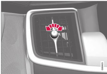
Stellrad der Belüftungsdüse<sup>2</sup>.
