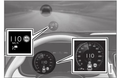
In der obigen Abbildung<sup>66</sup> ist die adaptive Geschwindigkeitsregelung auf 110 km/h (68 mph) eingestellt, und das Fahrzeug folgt einem vorausfahrenden Fahrzeug mit der gleichen Geschwindigkeit.
