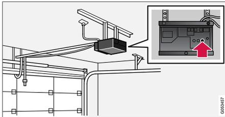
4. Finden Sie die Anlerntaste<sup>33</sup> am Empfänger, z. B. Garagentor. Die Platzierung ist normalerweise in der Nähe der Antennenfassung am Empfänger.
