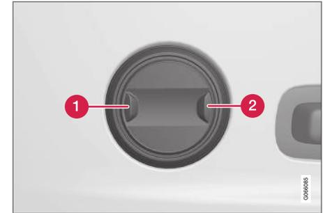
1. Drücken Sie den vorderen Teil **1** des runden Schalters, um die Lendenwirbelstütze zu erhöhen.
