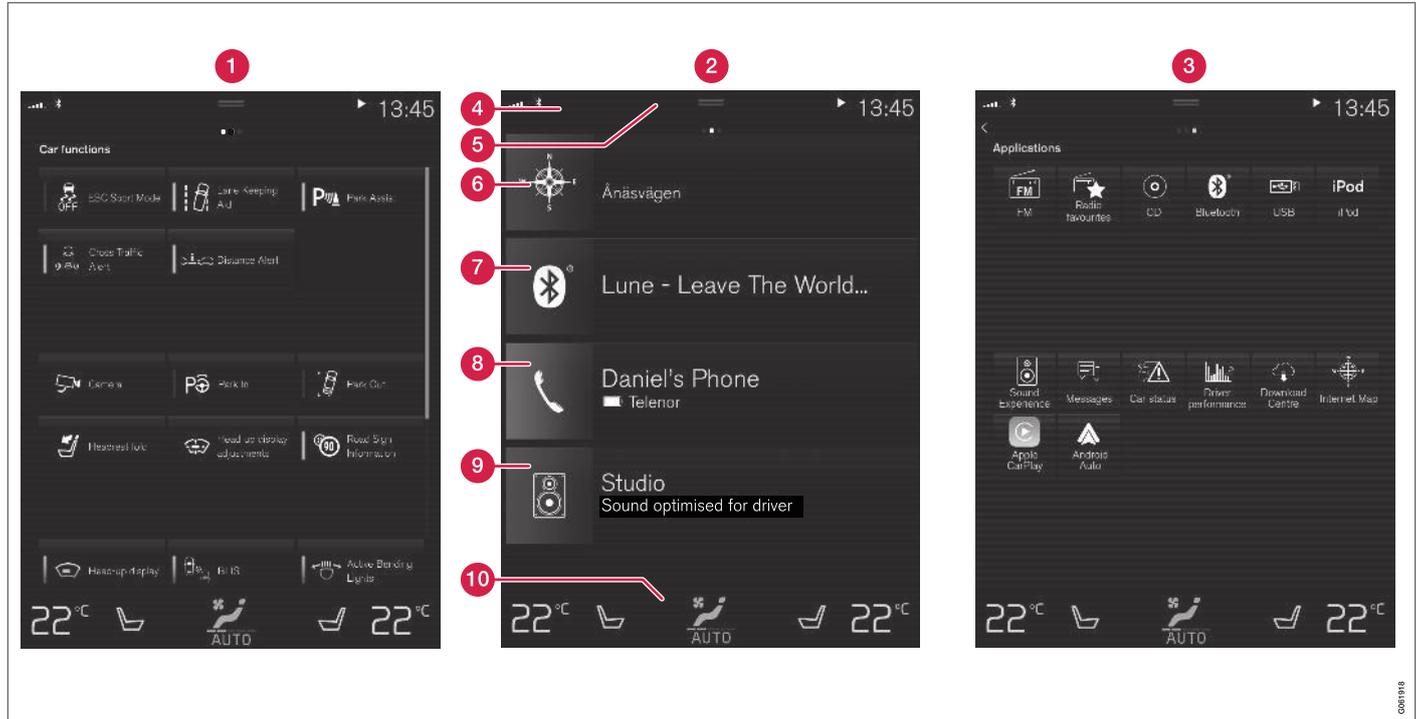
Drei der Hauptansichten des Displays in der Mittelkonsole. Streichen Sie nach rechts bzw. links über das Display, um zur Ansicht Funktionen bzw. Apps zu gelangen<sup>9</sup>.
