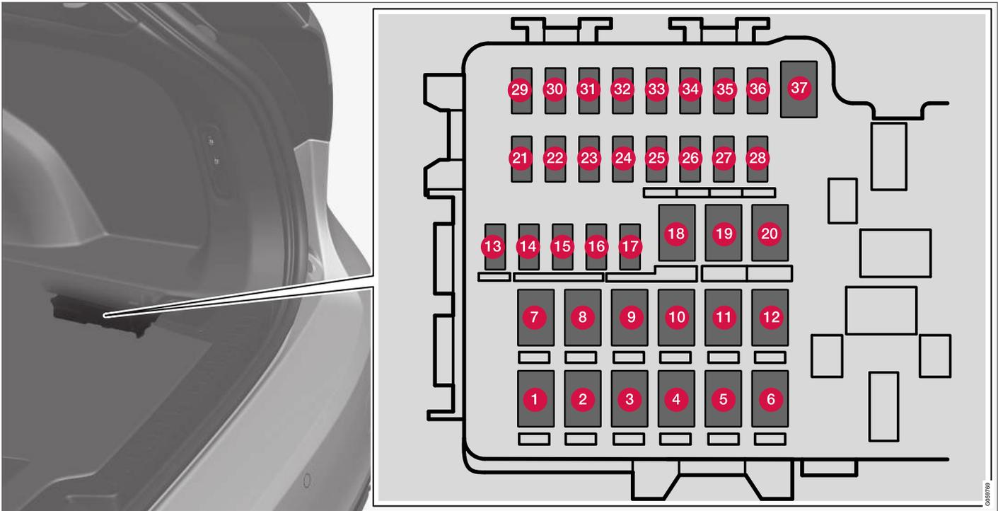
Der Sicherungskasten befindet auf der rechten Seite.
