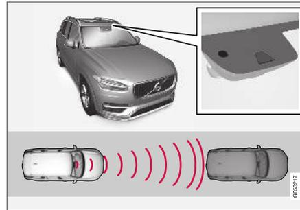
Lage von Kamera- und Radarsensor<sup>80</sup>.
