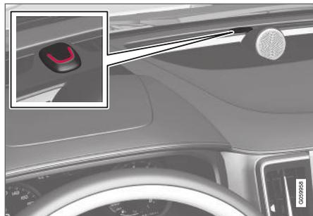
Eine rote Leuchtdiode am Armaturenbrett zeigt den Status der Alarmanlage an:
