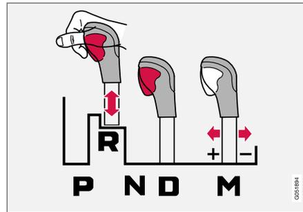
Der Wählhebel kann frei zwischen den Stellungen **N** und **D** vor- und zurückbewegt werden. Die übrigen Stellungen können mit der Sperrtaste am Wählhebel freigegeben werden.
