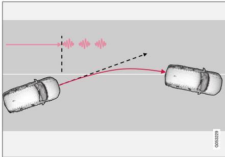
Der Spurassistent warnt den Fahrer mit Lenkradvibrationen<sup>115</sup>.
