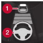
Nur wenn die Farbe des Lenkradsymbols (2) von GRAU zu GRÜN wechselt, ist die Lenkunterstützung durch Pilot Assist aktiviert.
