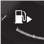
Auf dem Fahrerdisplay zeigt ein Pfeil neben dem Tanksäulensymbol an, auf welcher Fahrzeugseite sich die Tankklappe befindet.
