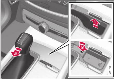
Wenn das Fahrzeug nicht gefahren werden kann, weil z. B. die Batterie entladen ist, muss der Wählhebel in Stellung **N** gebracht werden, damit das Fahrzeug bewegt werden kann.
