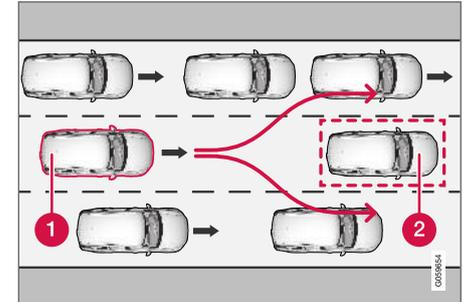
Das eigene Fahrzeug (1) „erkennt“ keine Möglichkeit, dem vorausfahrenden Fahrzeug (2) auszuweichen und wird daher ggf. schon früher automatisch abgebremst.
