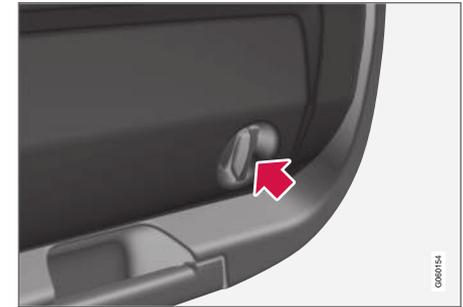
1. Die Innenverkleidung der Heckklappe lösen, indem zunächst die beiden Drehgriffe um eine Vierteldrehung gegen den Uhrzeigersinn gedreht werden und dann die Verkleidung ausgehakt wird. Die Abdeckung zur Seite legen.
