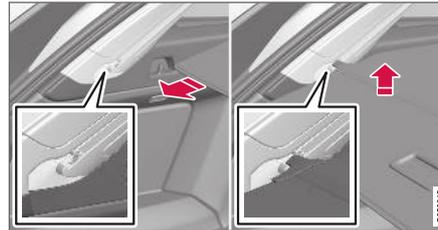
1. Den Griff fassen und die Gepäckraumabdeckung oberhalb der Seitenverkleidungen des Kofferraums herausziehen. Bis zur Endstellung herausziehen.
