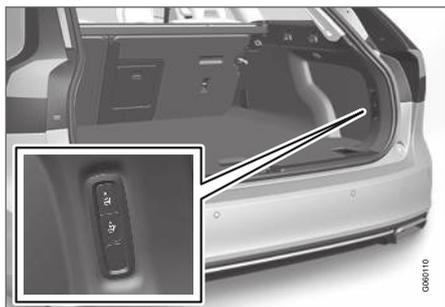
Ein Umklappen der Rückenlehne ist nur möglich, wenn das Fahrzeug steht und die Heckklappe geöffnet ist. Kontrollieren, dass sich keine Personen oder Gegenstände auf den Rücksitzen befinden.
