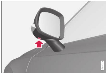
Die Seitenkameras<sup>128</sup> befinden sich in den Seitenspiegeln.
