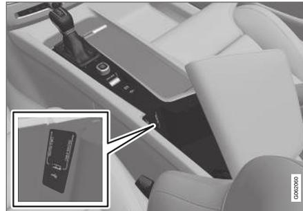
USB-Anschlüsse (Typ A) in der Tunnelkonsole. Richten Sie das Kabel nach vorn aus, damit es beim Schließen des Deckels nicht eingeklemmt wird.
