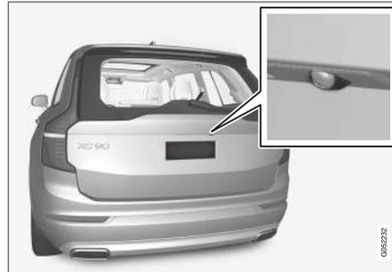
Die nach hinten gerichtete Kamera<sup>127</sup> befindet sich über dem Nummernschild.
