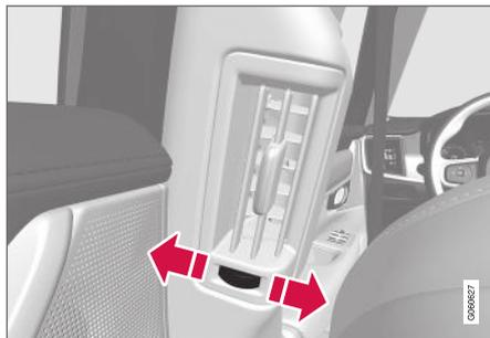
Stellrad der Belüftungsdüse<sup>2</sup>.
