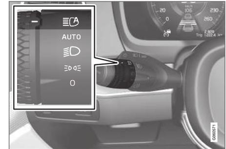
Das automatische Fernlicht wird mit dem Drehring am Lenkradhebel in Stellung **AUTO** eingeschaltet.
