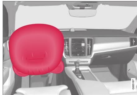
Lenkrad-Airbag und Knie-Airbag<sup>1</sup> am Fahrersitz.
