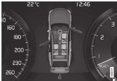
Grafik im Fahrerdisplay mit verschiedenen Arten von Warnungen. Die Warnfarbe an Türe und Heckklappe ist von der Geschwindigkeit des Fahrzeugs abhängig.
