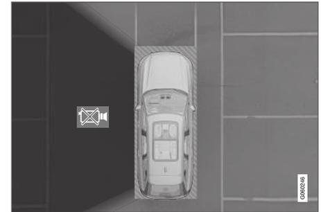
Hier ist die Kamera auf der linken Fahrzeugseite defekt.
