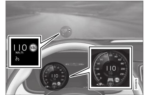
In der obigen Abbildung<sup>74</sup> ist die Funktion Pilot Assist auf 110 km/h (68 mph) eingestellt, und das Fahrzeug kann keinem vorausfahrenden Fahrzeug folgen.
