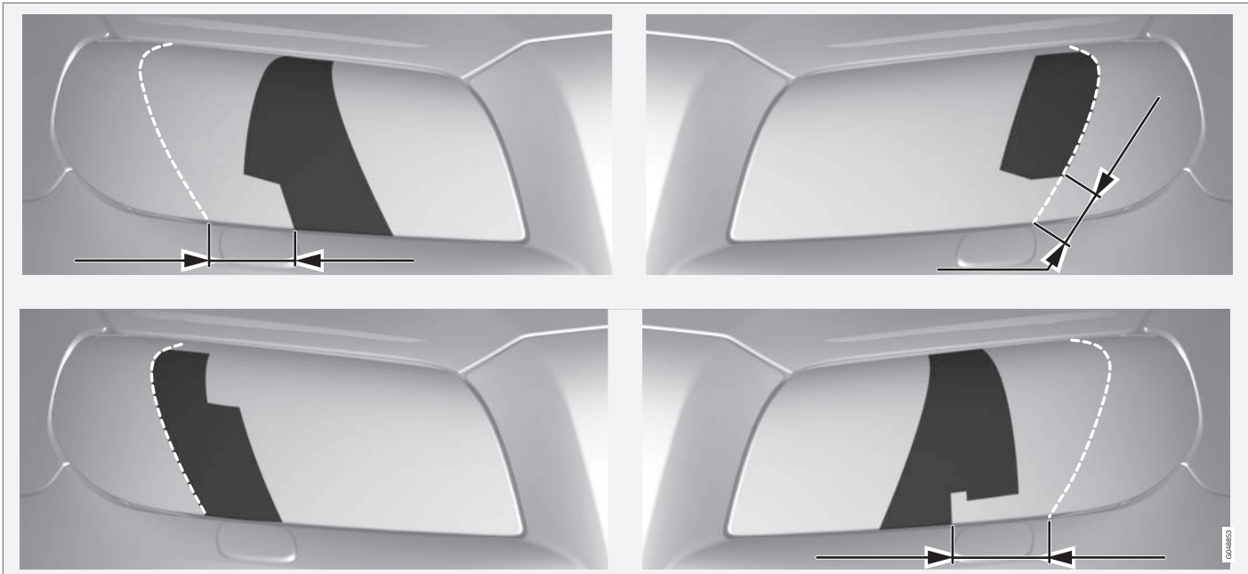
Línea superior: automóvil con volante a la izquierda, plantillas A y B. Línea inferior: automóvil con volante a la derecha, plantillas C y D.
