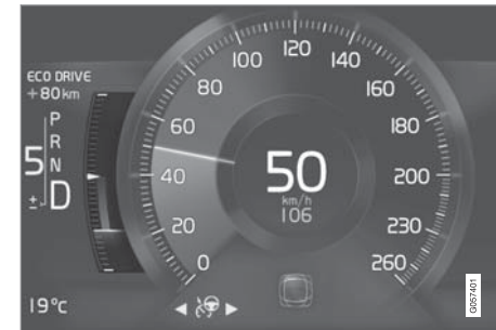
เกจวัด Eco บนจอแสดงผลสำหรับคนขับขนาด 8 นิ้ว
