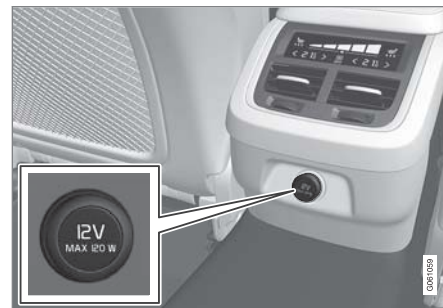
ปลั๊กไฟ 12 โวลต์ที่คอนโซลบริเวณโพงเพลากลาง, ที่นั่งด้านหลัง
