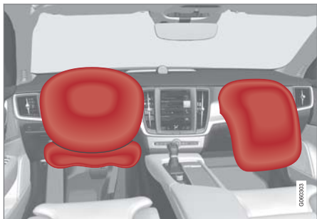
ถุงลมนิรภัยคนขับและถุงลมนิรภัยผู้โดยสาร 1
