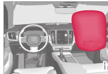
Czołowa poduszka powietrzna pasażera przedniego fotela.
