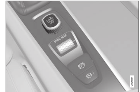
Pokrętko rozruchu na konsoli między fotelami.
