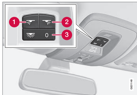
Interrupteurs d'éclairage, éclairage de pavillon avant
