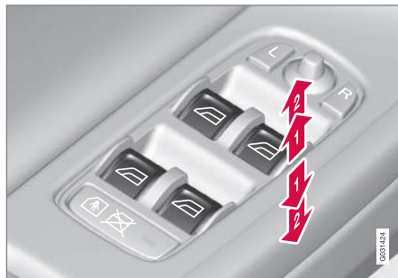
Accionamiento de los elevallunas eléctricos.
