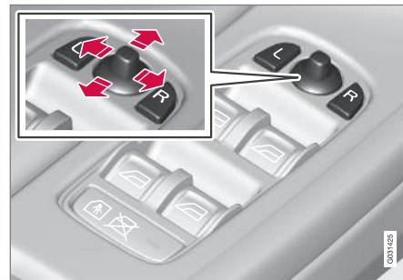
Mando de los retrovisores exteriores.
