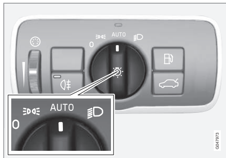
Mando de las luces en la posición AUTO .
