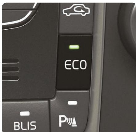
Une pression sur le bouton **ECO** active un programme de conduite optimal et économique en carburant impliquant les modifications suivantes :
