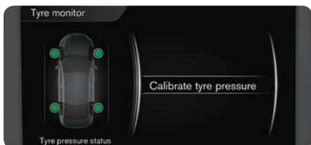
Il est toujours nécessaire d'effectuer un étalonnage après le remplacement d'un pneu ou un changement de la pression de gonflage. Le système doit être étalonné si le témoin (U) s'allume. Procédez comme suit :
