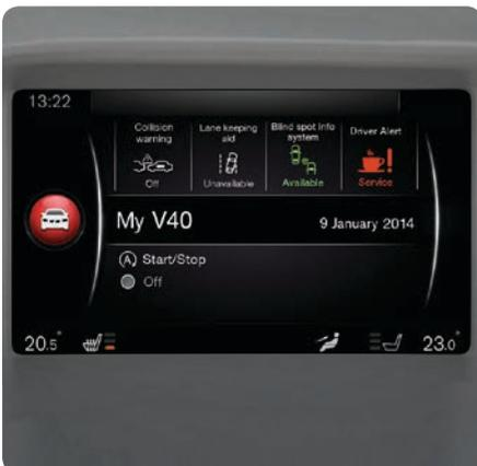
La section **MY CAR** traite de nombreuses fonctions de la voiture, comme les paramètres de l'horloge, les rétroviseurs extérieurs et les serrures par exemple.
