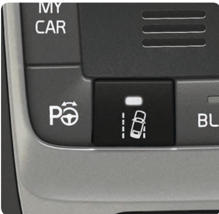
Si la voiture se met à dévier, LKA la remet activement dans sa voie à l'aide d'un léger couple dans le volant. Si la voiture dépasse un marquage au sol latéral, LKA vous avertit par des vibrations dans le volant.
