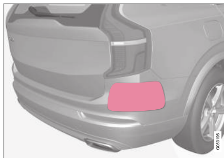
Posizione dei gruppi radar posteriori. Tenere pulita l'area evidenziata, sia sul lato sinistro che sul lato destro.
