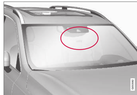
Posizione del gruppo radar.
