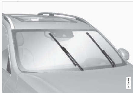
Pióra wycieraczek w pozycji serwisowej.
