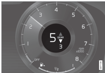
Wskaźnik zmiany biegu na 12-calowym wyświetlaczu kierowcy*.
