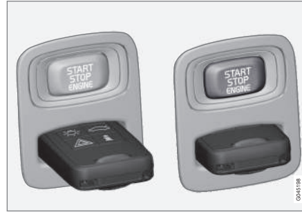
Contacteur d'allumage avec télécommande retirée/insérée.
