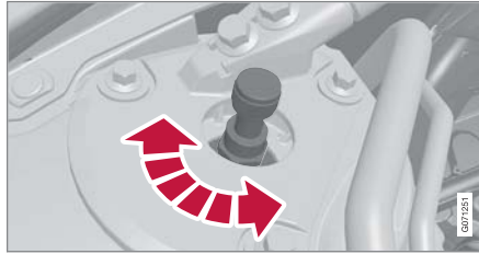
أدر مقبض الضابط باتجاه عقارب الساعة وعكس اتجاه عقارب الساعة على التوالي لتغيير وضع الضبط.
