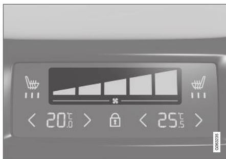
Ventilatorregeling op klimaatpaneel achter op tunnel-console.
