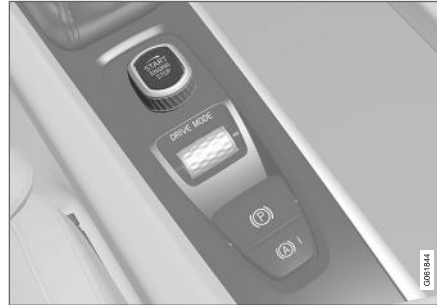
De startknop op de tunnelconsole.
