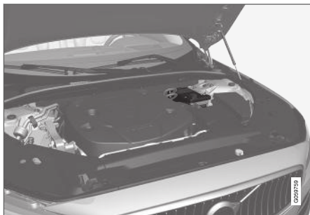
De hulpaccu zit in een bak naast de veerpootbevestiging.
