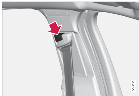
シートベルト高さ調節ボタンを押して、ベルトを上下に動かしてください。ベルトがのどにかからない範囲で、ベルトをできるだけ高い位置に配置してください。
