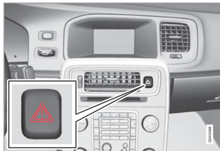
非常点滅灯ボタン
