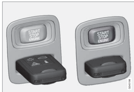
リモートコントロールキーを抜いた/差し込んだ状態のイグニッションスイッチ
