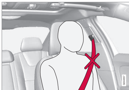
Λανθασμένη χρήση ζώνης ασφαλείας. Η ζώνη πρέπει να εφάπτεται στον ώμο.
