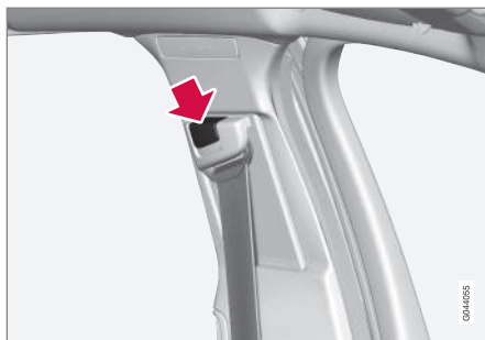
Ρύθμιση ύψους ζώνης ασφαλείας. Πιέστε το κουμπί και μετακινήστε την ασφάλεια κάθετα. Τοποθετήστε τη ζώνη όσο τον δυνατόν ψηλότερα χωρίς να τρίβεται στο λαιμό σας.
