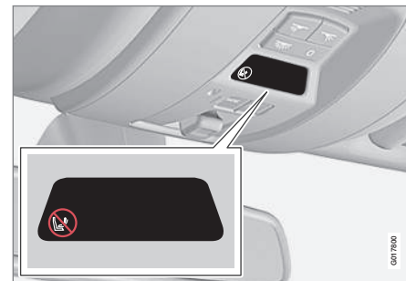
Ενδεικτική λυχνία που υποδεικνύει ότι ο αερόσακος συνοδηγού είναι ενεργοποιημένος.
