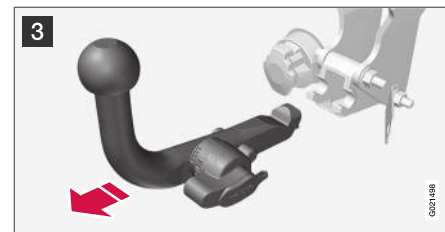
3 Continuez à tourner le bouton de verrouillage aussi loin que possible. Maintenez-le dans cette position tout en tirant la boule vers l'arrière et vers le haut.
