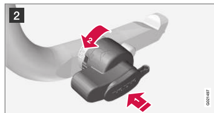
2 Enfoncez le bouton de verrouillage (1) et faites-le pivoter dans le sens inverse des aiguilles d'une montre (2) jusqu'à ce qu'un dé clic se fasse entendre.
