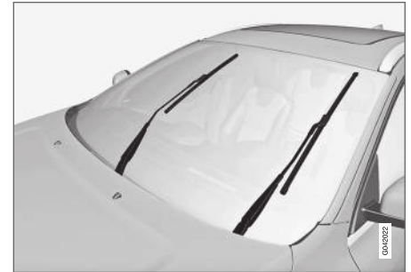
Balais d'essuie-glace en position d'entretien.
