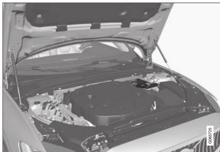
Stödbatteriet är placerat i motorrummet.
