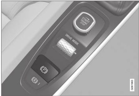
Reglaget för parkeringsbromsen är placerad i tunnelkonsolen mellan stolarna.
